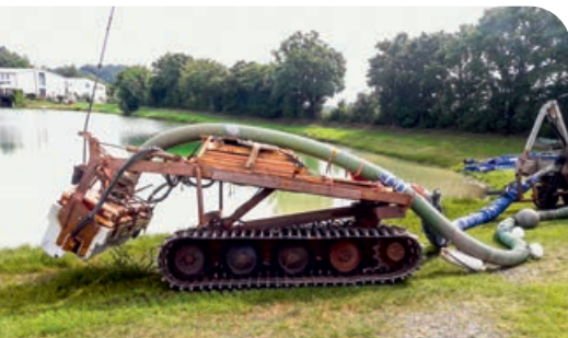
Der Saugroboter, der unter Wasser im Einsatz war.
