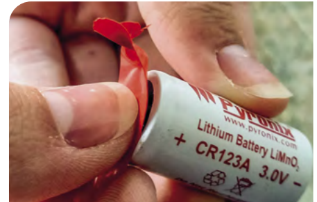
Lithiumbatterie – bitte an den Polen abkleben
