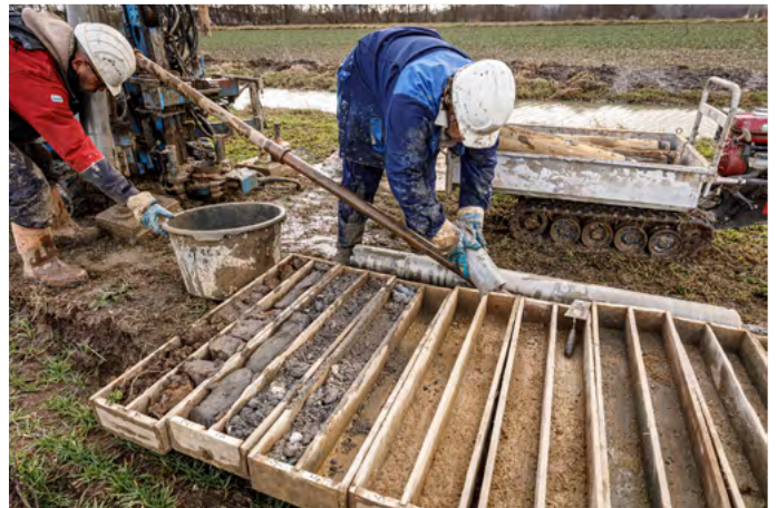
Die Bohrkern werden anschließend im Labor untersucht.
